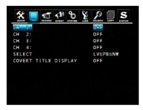
SELECT: "LV&PB&NW", "PB&NW", "LV&NW", "LV&PB", "NETWORK", "PLAY" and "LIVE".
